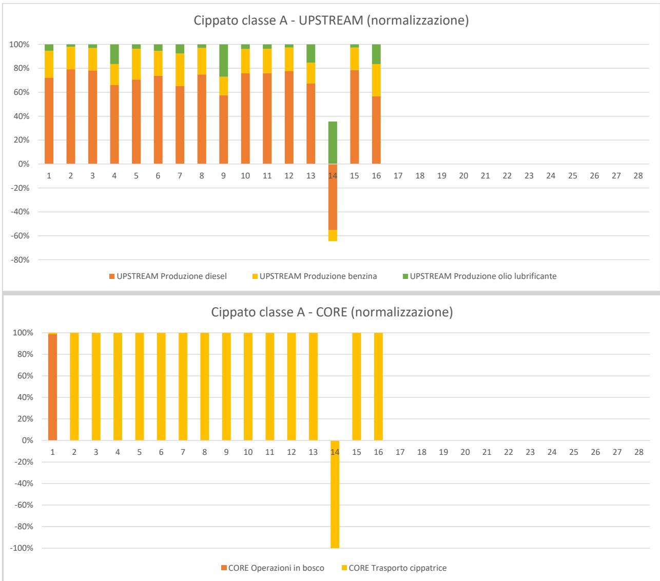
Figura 6 – Cippato di classe A – Normalizzazione: contributo processi all’impatto delle fasi UPSTREAM e CORE
